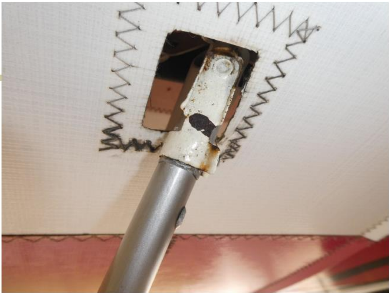
機翼快拆插銷銹蝕
