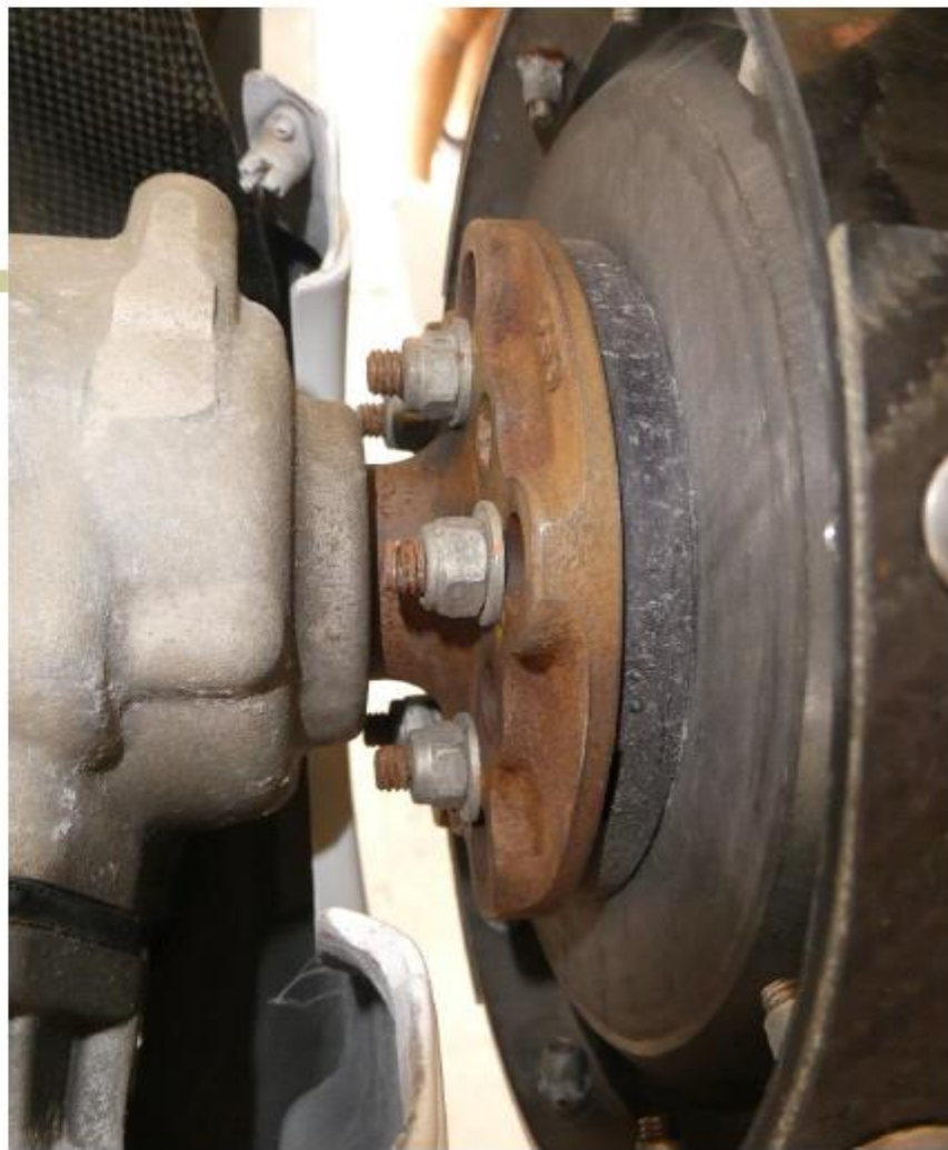
螺旋槳傳動軸盤銹蝕
