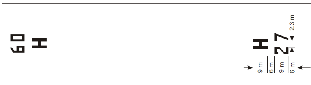
圖 5.2-4 跑道型最後進離場區方位及識別標線示意圖
